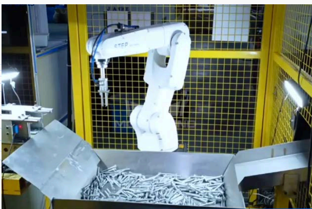
Bin picking de elementos metálicos
